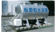
移動式給水タンク
